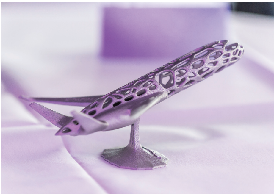
Scalimolly®-Bauteil der APWORKS GmbH, einer Tochterfirma der Premium AEROTEC GmbH, die sich auf den metallischen 3D-Druck spezialisiert hat.
