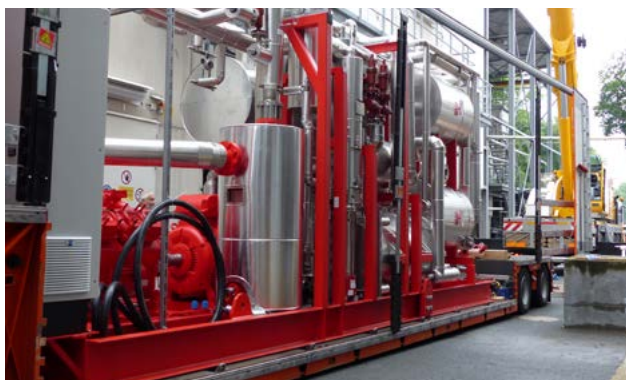
Die Hochtemperaturwärmepumpe „Calora“ kann Wärme bis zu 150 °C für industrielle Anwendungen oder kommunale Nah- und Fernwärmenetze bereitstellen
