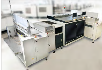
ICT-Flash-Linie mit zwei KT2000i; Bildquelle: Kabtec AG
