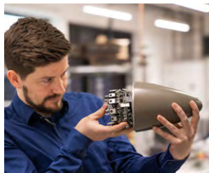
15-kW-Mehrphasen-Wechselrich- ter, vollständig integriert in den aerodynamischen Nosecone einer Elektromotor-Gondel; Bildquelle: Fraunhofer IISB/Elisabeth Iglhaut
