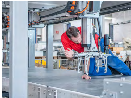
Montage einer Verpackungsanlage im Krones Werk Rosenheim. Bildquelle Bild 1 – 4: Krones AG
