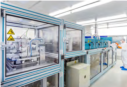
Beschichtungsanlage zur Herstellung von Lithium-Ionen-Batterieelektroden; Bildquelle: iwb
