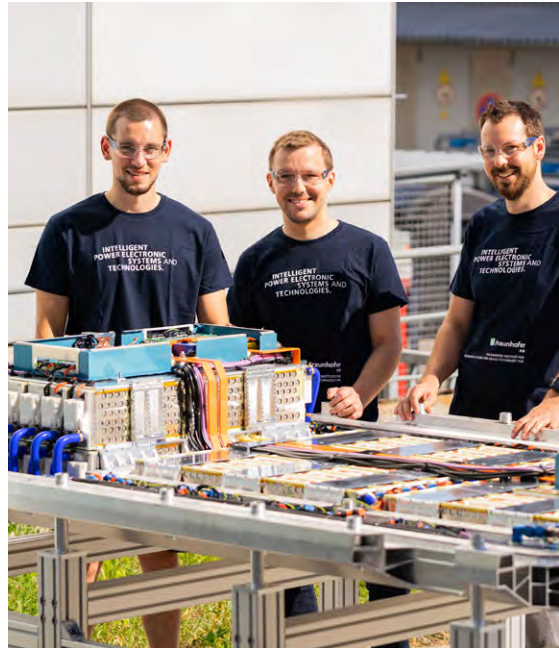
Schnellladefähige, gewichtsoptimierte, modulare 800-V-Hochleis- tungs-Traktionsbatterie; Bildquelle: Fraunhofer IISB/Thomas Richter
