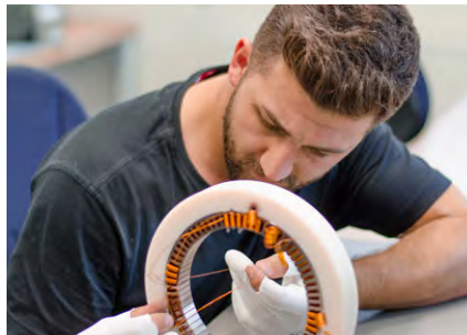
Direktbewicklung einer konzentrischen Wicklung; Bildquelle: MACHmotors GmbH
