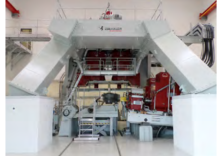
Hubschrauber-Getriebe-Prüfstand; Bildquelle: RENK
