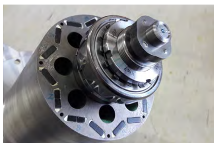
Rotor mit vergrabenen Magneten; Bildquelle: MACHmotors GmbH
