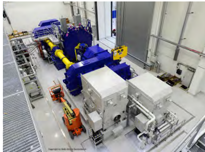
Luftfahrt-Getriebe-Prüfstand; Bildquelle: Rolls-Royce
