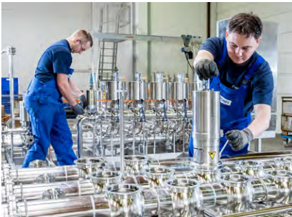
Die Installation von Ventilen in der Krones Prozesstechnik
