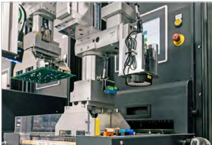
KT500 ICT-Flash-Zelle mit Portal- und Doppel-Greifersystem; Bildquelle: Kabtec AG
