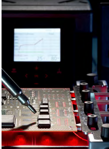
ESA Standard: Einbau eines SMT-Prozessors mittels Temperaturkontrollierter Heißluft und Infrarot-Unterheizung im Lehtgang Verarbeitung von Oberflächenmontierten Bauteilen nach ECSS-70-38
