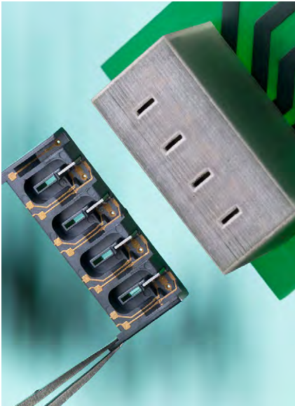
Drahtloser intelligenter Leiterplatten Steckverbinder zur kontinuierlichen Messung von Kontakttemperatur und Strombelastung des einzelnen Kontaktes als Basisdaten für vorbeugende Wartung. Bildquelle Bild 1 + 2: Fraunhofer EMFT/ Bernd Müller
