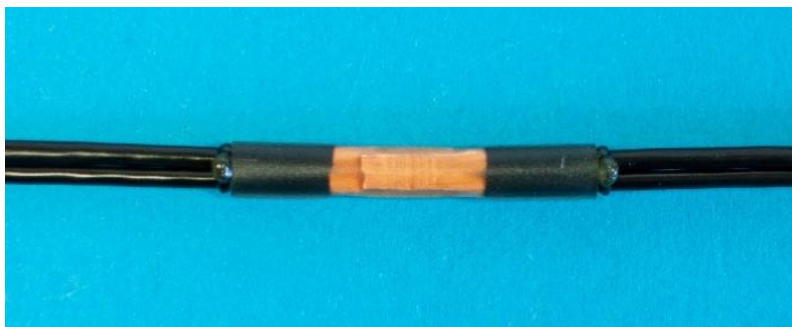
Abbildung 7-52: Kleberaustritt am Schrumpfschlauchende
