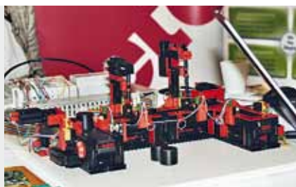
Mit ROOM programmierte Software steuert Demo-Maschine mit Fischertechnik
